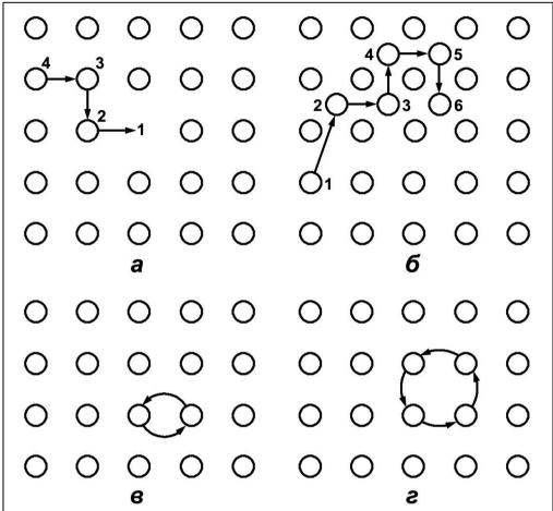
Рис. 5.1. Атомные перемещения, которые приводят к диффузии: a — движение атомов по вакансиям;  $\delta$  — движение атомов внедрения;  $\epsilon$  — обмен местами двух атомов;  $\epsilon$  — кольцевой обмен четырех атомов.
