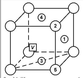
Рис. 5.4. Обмен местами между вакансией V и атомом 1 в г. ц. к. структуре. Четыре других атома (2, 3, 4, 5) непосредственно взаимодействуют с диффундирующим атомом, когда он находится в среднем положении.
