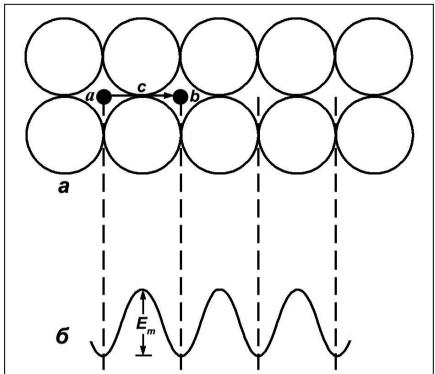
Рис. 5.2. Диффузия по междоузлиям: a — схема диффузии;  $\delta$  — потенциальная энергия кристалла в зависимости от расположения диффундирующего атома.
