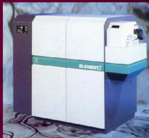
ИСП-массспектрометр. Общая база стандар- тов составляется совместно с ГЕОХИ СО РАН. Чувствительность – 10^{-13} мас %
