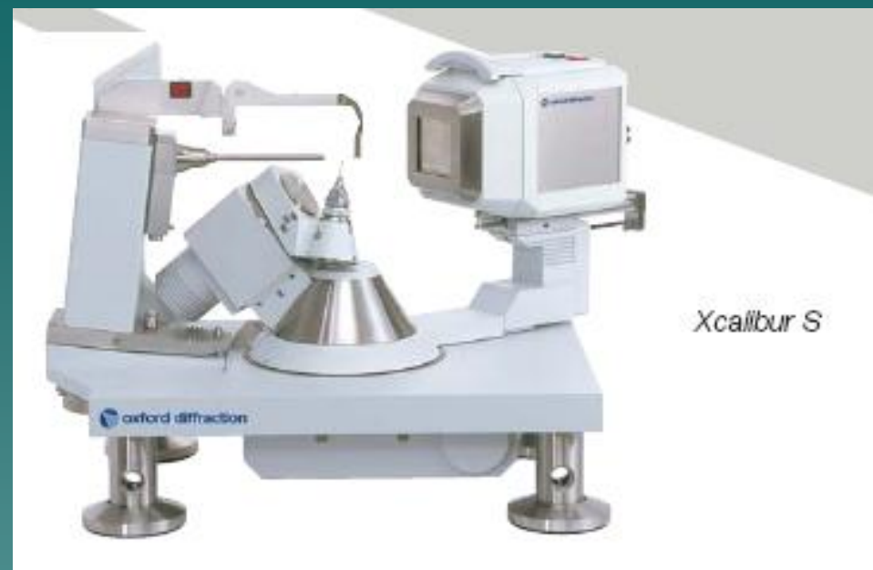
Монокристалльный рентгеновский дифрактометр с двумерным позиционно-чувствительным детектором (поставка в 2008г.)
